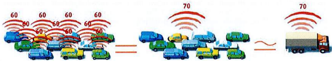
Figure 4 : L'addition de dix sources sonores de même intensité Source : www.bruitparif.fr
